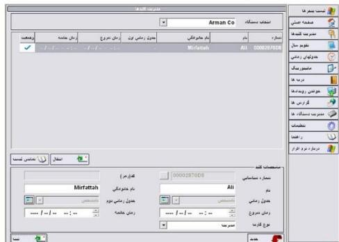
کنترلر M300 به صورت عدد هنگز از طریق نرم افزار کنترل تردد ثبت نمائید به عنوان مثال ثبت اثر انگشت با ۲۰۱ ID باید بر روی نرم افزار M300 در بخش مدیریت کلید ها قسمت شماره شناسائی، ۱۴ وارد شود. همچنین برای کد با ID ۵۰۱ شناسه ۱F5 و برای کارت با ID ۱۰۰۱ شناسه ۳E9 وارد شود.
